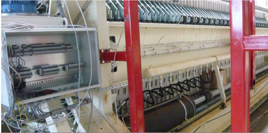
Hydraulic cylinder for sludge dehydrate Vérin hydraulique pour déshydrater les boues Hydraulikzylinder zur Schlamm entwässerung
